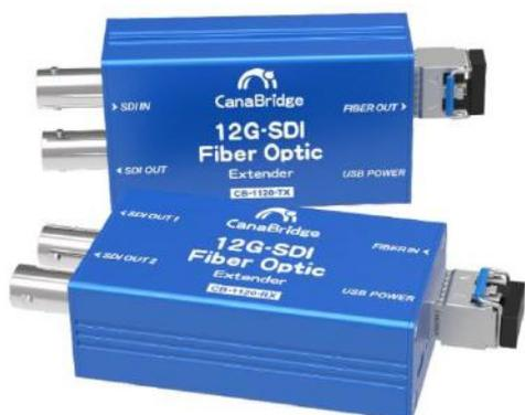
CB-1120 光纤延长器为包含发射端/接收端的套件，支持单模LC 单向光纤传输。传输距离达10 公里。该微型扩展方案支持所有分辨率高达4K60p的所有SDI 格式(最大带宽: 12Gbps) 以及音频和元数据。发射端含SDI环出；接收端为双SDI输出。支持12G/6G/3G/HD/SD-SDI信号格式。
