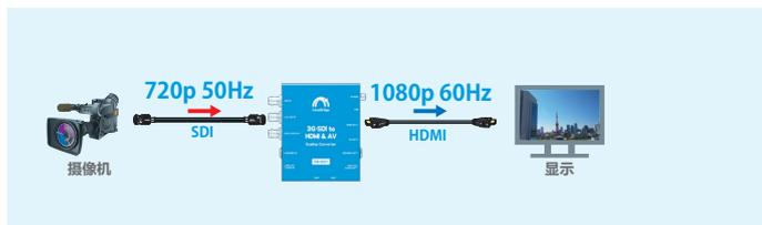
AES/EBU、模拟音频、SDI 嵌入音频的输入信号可以经 HDMI 输出。此外, SDI 嵌入音频信号可以解嵌并发送到音频信号输出端。标准 1/4" (6.3 毫米) 音频插头或小型 1/8" (3.5 毫米) 音频接口, 无需采购定制电缆。
